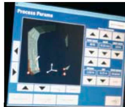
Kontrollmonitor zur Erfassung der Daten für die Steuerung der MEYCO® Logica.
